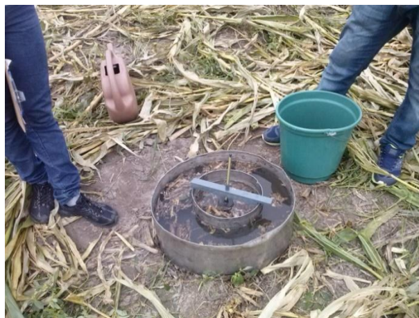
Figura 2. Duplos cilindros infiltrômetros utilizados nos testes de infiltração da água no solo.
